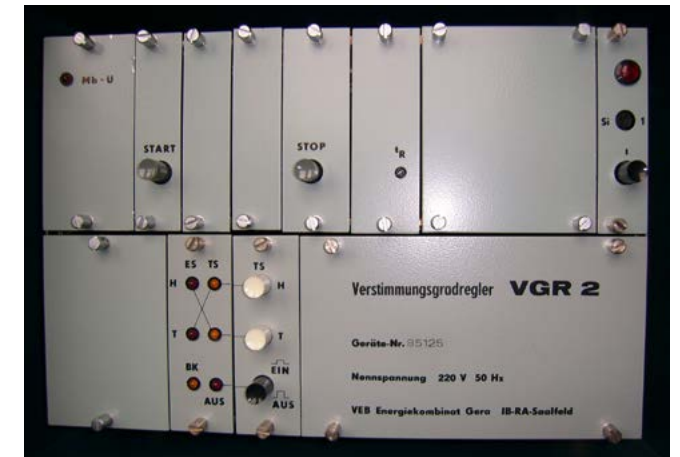
Bild 50: Verstimmungsgradregler VGR2, BRA Saalfeld
