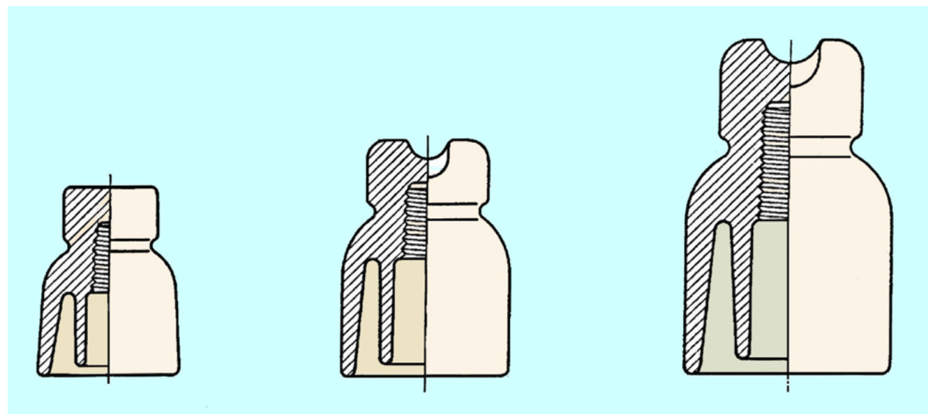
Doppelglocken nach Chauvin, erste in Preußen genormte Porzellan-Isolatoren, 1862
