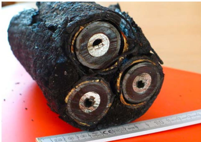
Bild 24: 50-kV-Ölkabel KW Gispersleben–UW Galgenberg
