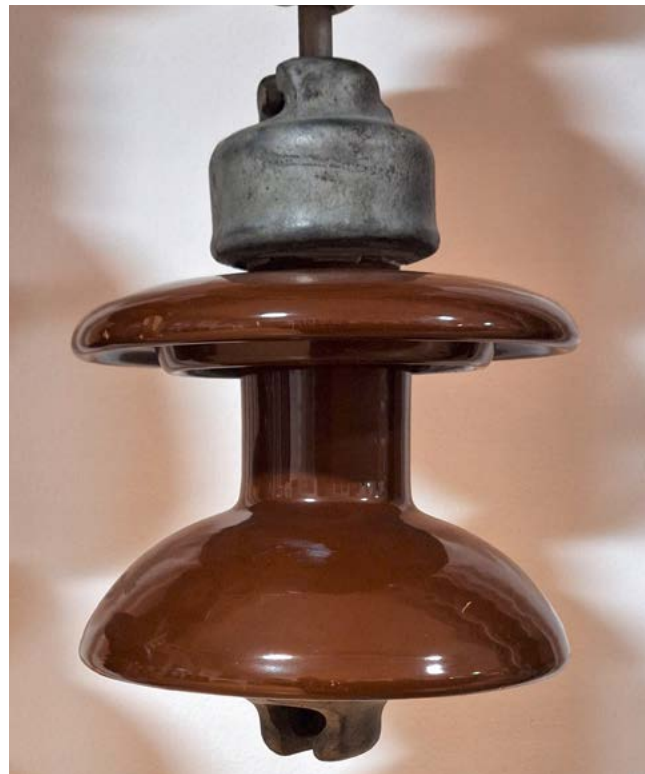
Vollkern- oder Motor-Isolator, Technische Sammlung Hermsdorf
