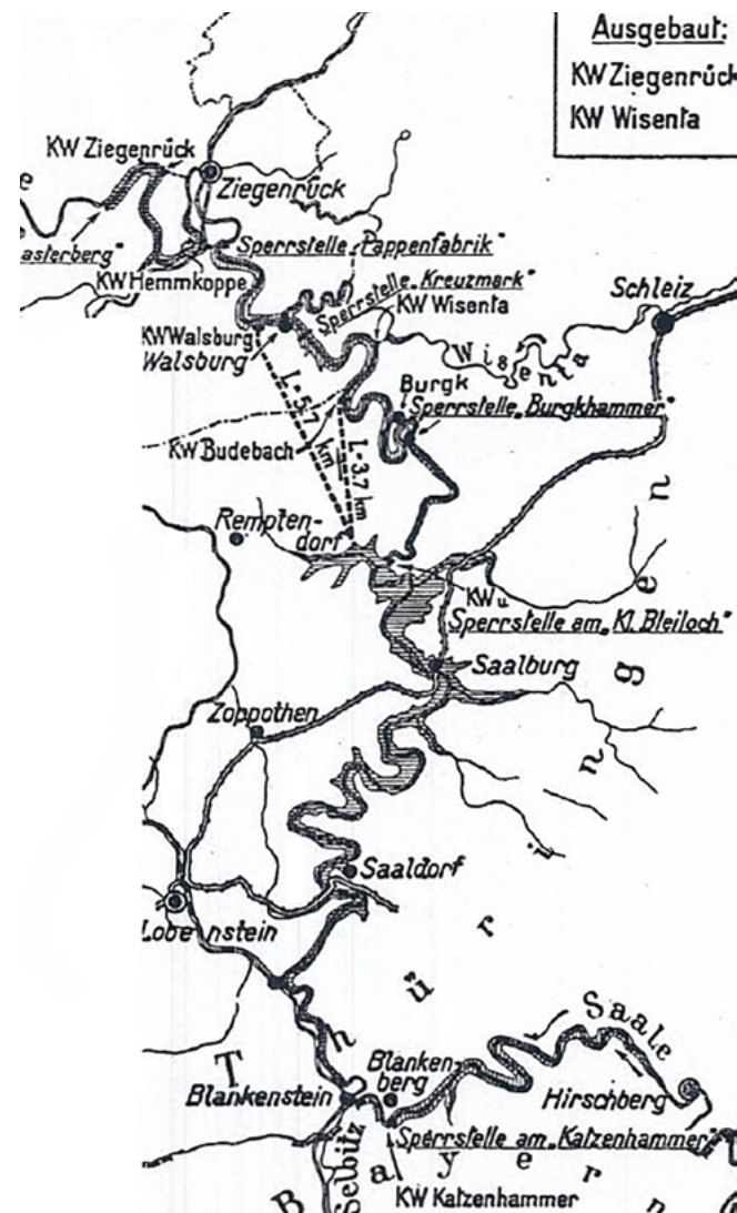
Bild 3: Planungen des Hydrotechnischen Büros der Zeiss-Stiftung zur Nutzung der Wasserkräfte zwischen Hirschberg und Ziegenrück. [6] Für die WKA Bleiloch wurden als Standorte neben der Staumauer auch die über Tunnel aus dem Retschenbachtal erschließbaren Standorte Walsburg und Budebach untersucht. Die beiden letztgenannten Standorte führten wegen der höheren nutzbaren Fallhöhe zu einem größeren Energiegewinn.
